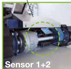
In ascending/descending, to make running speed faster/slower. In descending, at the edge of landing space, to make the rail frame bent. Kontrolliert die Geschwindigkeit bei Auf- und Abfahrten. Bewirkt bei Abwärtsfahrt die Auslösung des flexiblen Rahmens
